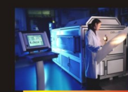
Reactor para el proceso de "Deposición por Vapores Químicos" @ T ≤ 2500°C
