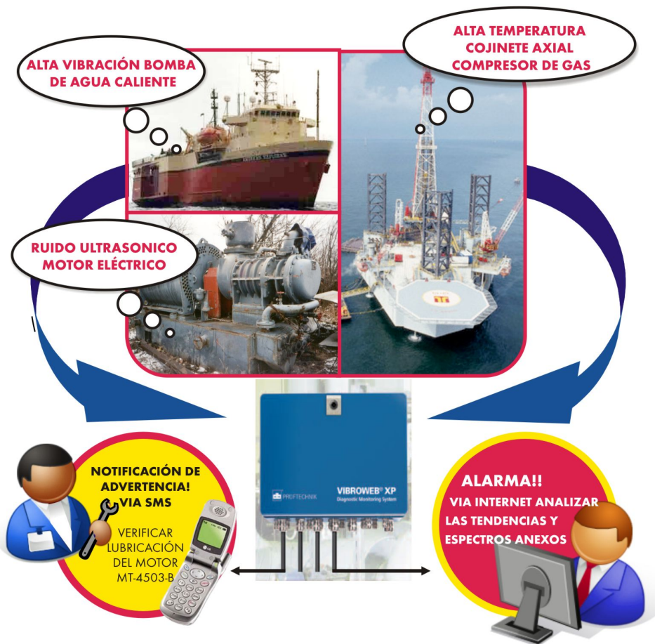
Figura 2. Este tipo de tratamiento de la información garantiza el acceso a datos originados en zonas lejanas, inaccesibles, peligrosas o inhóspitas. Estos datos son distribuidos a diferentes niveles de la organización de mantenimiento y confiabilidad de acuerdo al estado de criticidad de la información. Las redes inalámbricas facilitan la comunicación de los datos potenciando la capacidad de detección y diagnóstico de problemas. Esto además representa importantes ahorros logísticos y económicos. La masificación y automatización de la colección de los datos garantizan detección más temprana de una mayor cantidad de fallas incipientes, generándose información vital para la optimización de la planificación y programación de las acciones preventivas y proactivas de mantenimiento.
